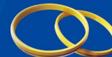
金属环垫由锻造及热处理和机械加工制成，是一种应用于油及气体的管体兰，压力容器，高速结合面，高温高压阀盖等的金属密封垫片，尤其压力、温度有波动的场合，仍能保持较好的密封件。常用的R型垫片按截面分为椭圆形或八角型，标准的R型环形垫片按API6A以及ASME B16.20标准尺寸制造，最高使用压力是10000PSI。在梯形槽法兰中八角垫与椭圆垫可以互换。RX型八角垫适用于压力增强的标准R型环状垫片，适合于R型一样的法兰槽密封面。BX型八角垫适用于压力增强并且设计应用高达15000PSI压力系统。有多种材质及形式适用于不同的设计操作要求，参考材质特性表。
